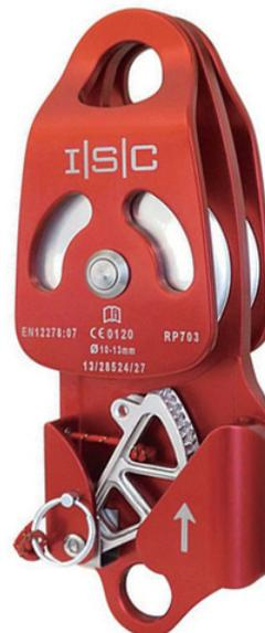
プログレスプーリーは2つのプーリーの間にセンタープレート、ロープの摩擦を減らすために再配置されたホイール、およびANSIのカリビナでさえ完全に回転できる定格ベケットを備えています。カム面は摩耗を最小限に抑えるために円錐形になっています。
