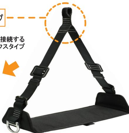
ハーネスでの活動を長時間続ける時に役立つワークシートです。ハーネスのフロントD環にカラビナまたは、リングキャッチで接続します。フィックスタイプはカラビナで下降器を接続できますのでブランコ作業に最適です。吊りベルトの長さを調節し、身体に受ける負担を大幅に軽減します。
