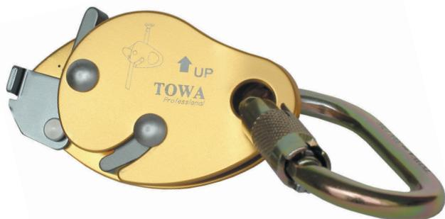
TOWA QQ フォールアレスターは先行型墜落防止器具です。とてもコンパクトでロープへの取り付けも簡単にできます。ロープアクセス・プランコ作業時において、万一の時にロックして墜落の危険を防止します。ブレーキカム搭載でパーキングポジションに切り替えれば、定位置作業やワークポジショニングを取ることができます。ホーリングシステムでメカニカルプルジックとして使用できます。
