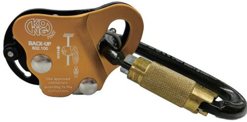
画期的な先行型墜落防止器具です。小型軽量でセットも簡単。本体に負荷がかかるとロックして、ブランク作業等における万一の墜落を阻止します。パーキングレバー搭載で、定位置作業やワークポジションを取る時にも最適です。※専用カラビナ付
