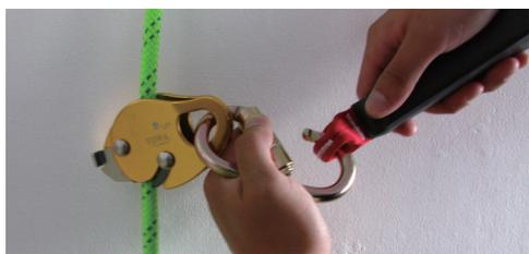
QQ 本体専用の付属カラビナにショックアブソーバースリングを使用して、ハーネスの支点に接続します。
