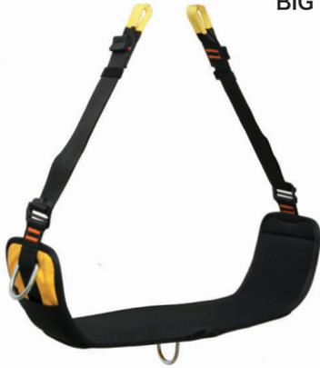
シンギングロック社製ワーク用ブランコです。吊りベルトの幅が45mmと安定性に優れています。ブランコの左右と下に付いているD環は25kgまで荷重をかけて使用が可能です。
