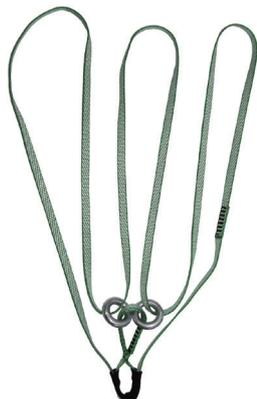
2ヶ所または3ヶ所の支点からY字型・W字型にしてマルチアンカーを構築できます。ビル屋上の丸環など強度に不安がある場合、複数の支点からトップアンカーを作れます。また、丸環同士の間でメインロープを設置することができます。
