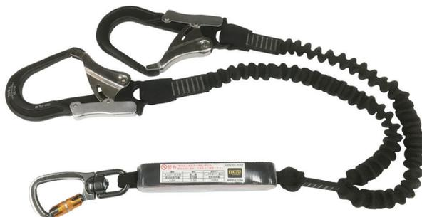
ツインランヤードは高所作業時に体勢を変える・場所を移動する等のフックを外す場合に、必ずいずれか一方のフックを掛け止めすることにより常に接続を実現し、墜落事故の発生を未然に防ぐ事ができます。
