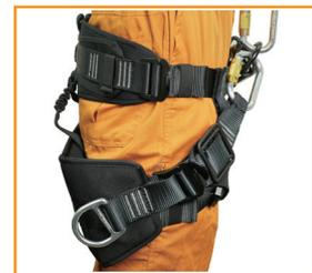
ハーネスでの活動を長時間続ける時に役立つワークシートです。ハーネスのフロントD環にカラビナまたは、リングキャッチで接続します。フィックスタイプはカラビナで下降器を接続できますのでブランコ作業に最適です。吊りベルトの長さを調節し、身体に受ける負担を大幅に軽減します。
