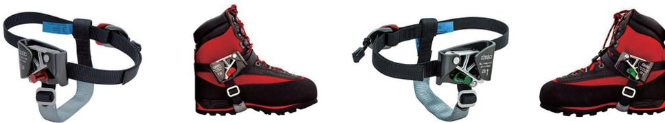
スライドフットアッセンダーは高所作業ユーザーのアドバイスのもと、使い勝手の良いアッセンダーとして開発されました。カムはハンドルアッセンダーと同じ大きさを使用しており、カムの歯はコーン型です。ロープの噛み合わせが良く、踏み出す時にスムーズでロープへの負担が軽減するよう工夫されています。カムの開閉スプリングの強さがロープに過度に食い込み入り、スムーズに上昇しロープから外れにくい。フットレバーの開閉がしやすく外しやすくできているので、もう片方の足でその操作ができます。フットレバーを使いカムをオープン状態にもできます。ストラップはダブルアジャスタビリティストラップです。外すためのつまみ、プルストラップがついているので、靴から外す時に便利です。またこのストラップは耐久性に優れ、ブーツにフィットして締めが出にくいストラップを使用しています。靴底の部分は長持ちするように二重構造になっています。
