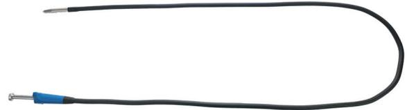
狭くて手の入らない場所や、水中に落としてしまった小物類を拾い上げるのに最適なツール。自動車や機械の手が届きにくい場所にアクセスするのにもオススメです。自在に曲げて使えるフレキシブルシャフトは長さが1500mmあり広範囲に届くようになります。磁石では拾えない樹脂、ゴム、アルミ製の小物でも3本爪により容易にキャッチできます。
