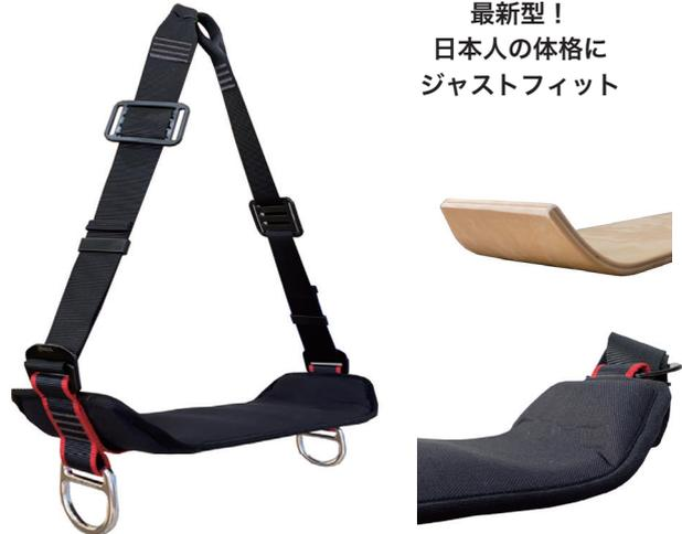
内芯のフィンランドパーチ材を湾曲させたワークシートが新登場。座板の端をめげることでフィット感が向上しました。ハーネス腹部のD環に接続して使用することで乗り込みの必要がなくなり、スムーズに作業を行えます。
