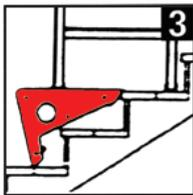
この機能は、カーペット、フローリング、コンクリート、レンガ、タイルあるいは複合材のステップで安全に使用できます。図のようにPiViTラダーツールの鼻部のクボミがステップの端にしっかりとかかるようにし、PiViTラダーツールの足は階段ステップの端から最低3cm離れるように設置して下さい。注意:階段の形によっては、PiViTラダーツールが合わない場合があります。
