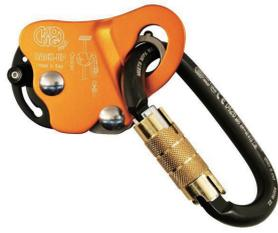
画期的な先行型墜落防止器具です。小型軽量でセットも簡単。本体に負荷がかかるとロックして、ブランコ作業等における万一の墜落を阻止します。パーキングレバー搭載で、定位作業やワークポジションを取るときにも最適です。
