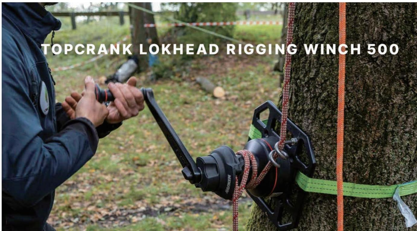
CE 認証を取得した軽量で持ち運びやすい当ウインチは、頑丈なプレートに取付けられていて耐久性や信頼性を保証できます。複雑なリギングのニーズに答え、精密な操作が可能する2速システムで設計されています。厳しい環境や遠隔地でも様々なマウンティング状況やリギングのオプションに適合でき、順応性が抜群です。安全が第一の理念を考慮し、ロックヘッド・ブレキング・システム（自己ロック）を搭載し、偶発的な物質の落下、手放しを防げます。安全を損なうことなくご使用いただけます。ラジアル・ウインチ 40.2STA をモデルに HARKEN カスタム「ロックヘッド・ブレキング・システム」、アルミ製パーツで構成され、タフなタスクを簡易に行えます。更に、酸化皮膜処理アルミのマウンティングプレートにより強度と耐腐食性が加わります。トップクランク・ロックヘッド・リギング・ウインチ 500 を使えば建設、レスキュー、重荷の取扱など、どんな場面でも作業効率アップに繋がります。キットは本体、取付け用マウンティング・プレート及び 254mmのウインチ・ハンドルが含まれます。
