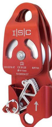
プログレスプーリーは2つのプーリーの間にセンタープレート、ロープの摩擦を減らすために再配置されたホイール、および ANSI のカラビナでさえ完全に回転できる定格ベケットを備えています。カム面は摩耗を最小限に抑えるために円錐形になっています。
