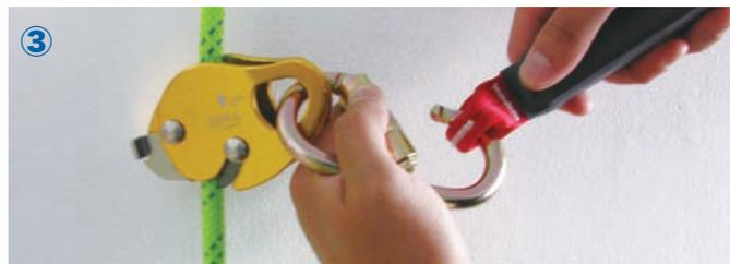
③ QQ 本体専用の付属カラビナにショックアブソーバリングを使用して、ハーネスの支点到に接続します。
