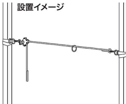
カラビナを支柱に取付け、ロープを引き中心にあるテンショナーナットを締め付けることで親綱として使用できます。
