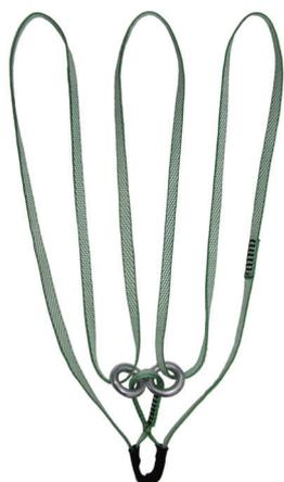
2ヶ所または3ヶ所の支点からY字型・W字型にしてマルチアンカーを構築できます。ビル屋上の丸環など強度に不安がある場合、複数の支点からトップアンカーを作れます。また、丸環同士の間でメインロープを設置することができます。ダイニーマスリング 12mm 製とナイロンスリング 20mm 製があります。
